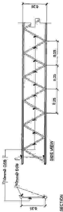
**FLOOR JOIST DETAIL**
